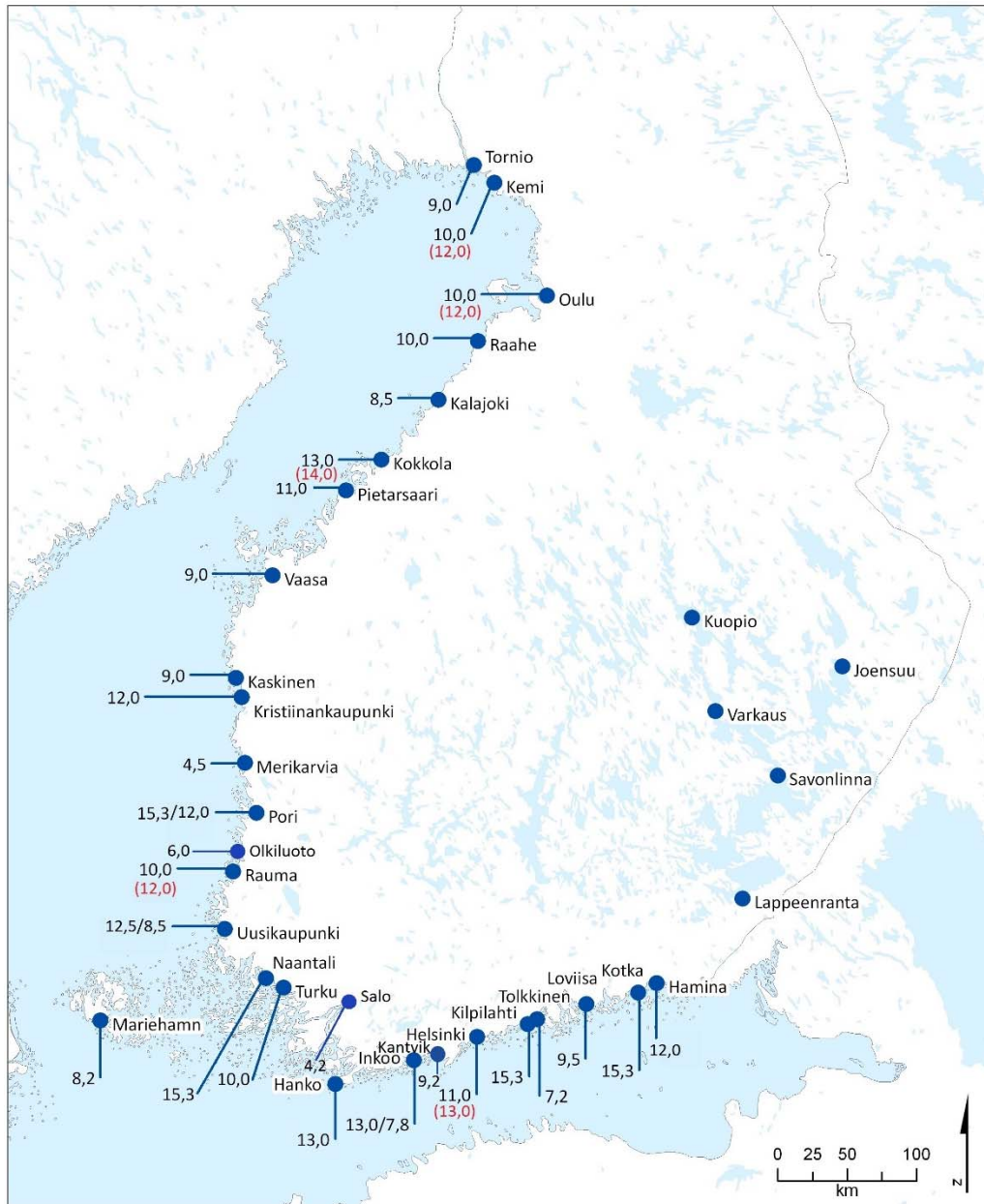
Kuva 6. Suomen Satamaliiton jäsensatamat ja Maarianhaminan satama sekä niihin johtavien syvimpien väylien kulkusyvytydet rannikon satamien osalta. Suluisissa punaisella on merkitty toteutus- tai suunnittelu- vaiheessa olevien väylien tulevat kulkusyvytydet.
