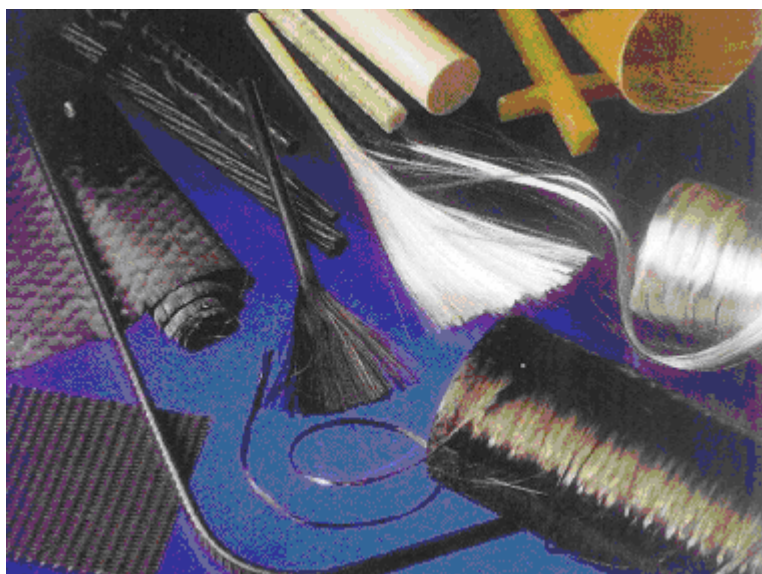
Kuva 1. Yleisesti käytettyjä lasi- ja hiilikuituja ja niistä tehtyjä raudoitteita korvaavia tuotteita / 32 /.
