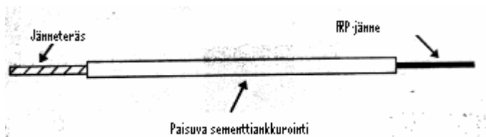
Kuva 3. Ei-metallisen jätteen liittäminen teräspunokseen / 21 /.
