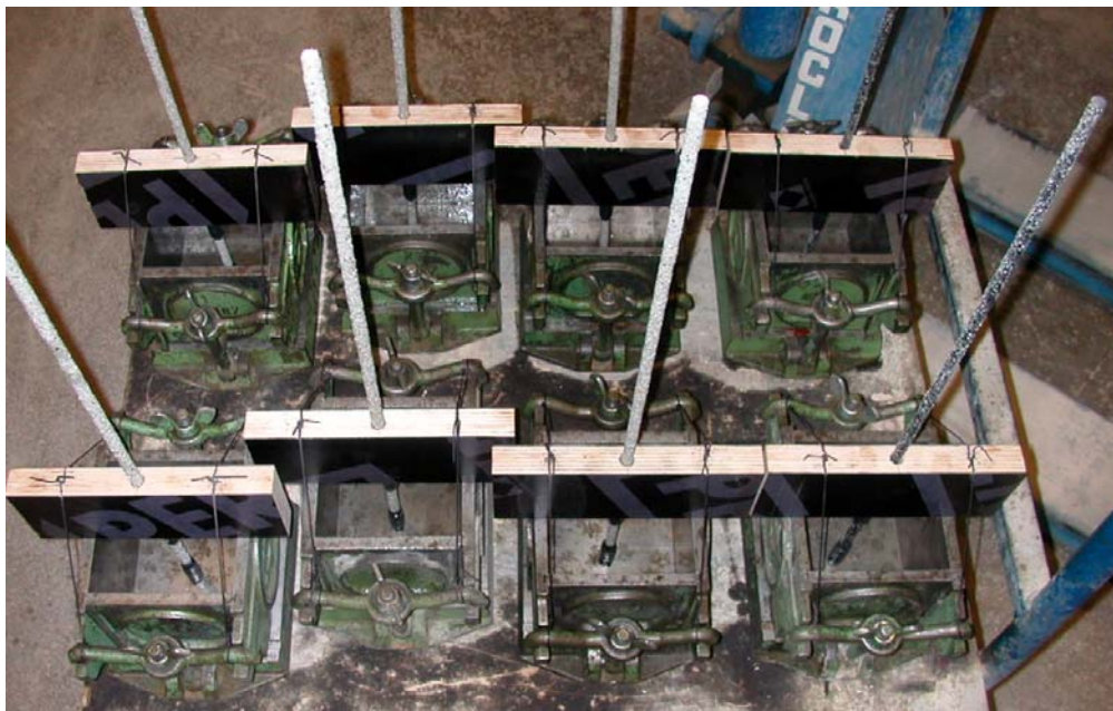
Kuva 1. Ulosvetokoekappaleiden valun muottivaihe.
