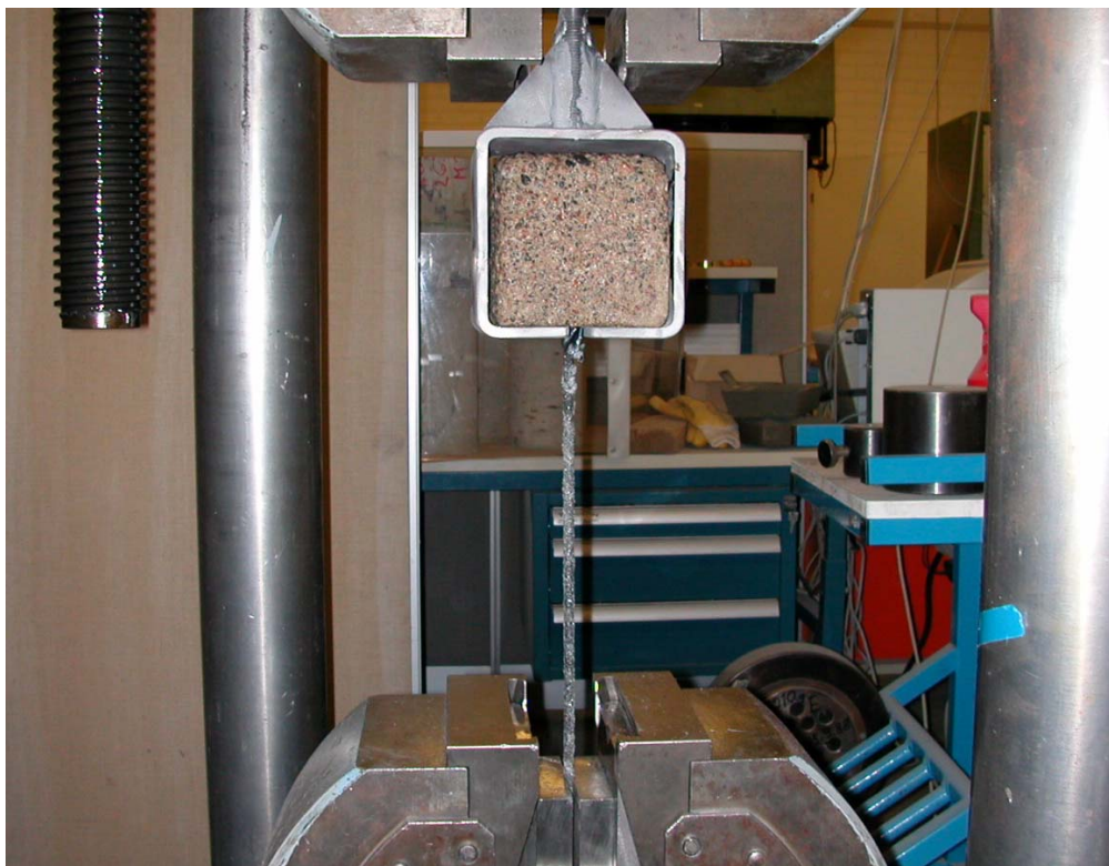
Kuva 2. Tartuntavetokoe. Koekappale pakkas-suolakokeen jälkeen.
