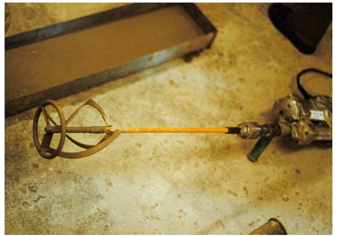
Kuva 9. Paikkauslaasti sekoitetaan porakoneeseen kiinnitetyllä siivikolla tai ...
