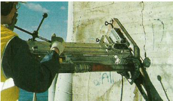
Kuva 5. Ennakkokokeen tulos tarkistetaan rakenteesta porattavasta näytteestä.
