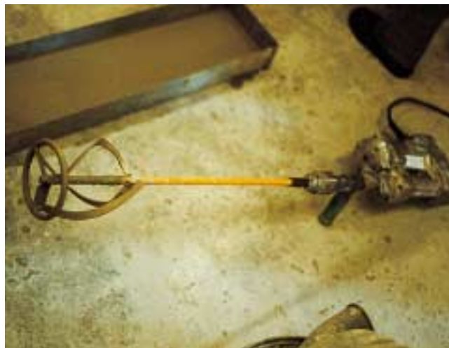
Kuva 13. Hyvä laastin sekoitussiivikko.
