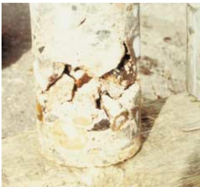
Kuva 2. Poranäytteen paljastama tyhjä tila kansilaatassa.
