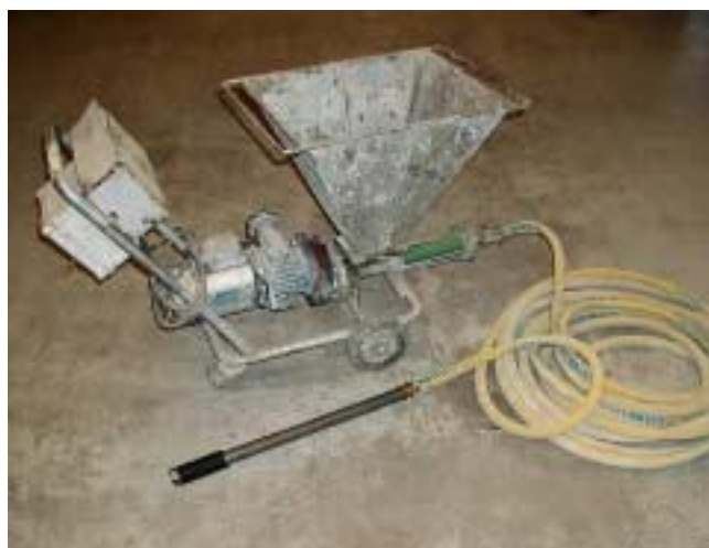
Kuva 15. Konepumppu ja injektointitulppa.
