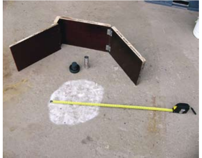
Kuva 18. Eristysalustan karheuden määrittäminen lasihelmimenetelmällä.
