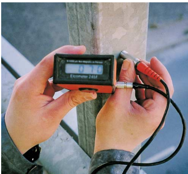
Kuva 2. Sinkkikerroksen ohenemista on seurattava määräjain tehtävillä mittauksilla.
