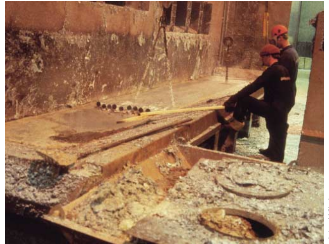
Kuva 7. Kuumasinkitysallas rajoittaa sinkittävän kappaleen kokoa.
