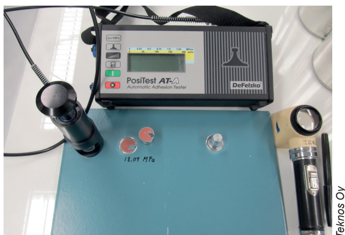
Kuva 1. Maalin tartunnan testausta laboratoriossa.
