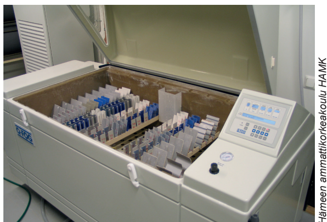
Kuva 2. Maalausjärjestelmän testauksessa käytetty korroosiotestilaite.
